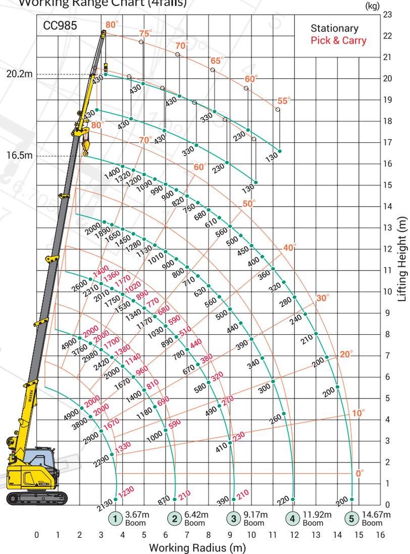
Le diagramme de portée montre la charge nominale totale, incluant la déformation de la flèche et de la fléchette/jib.
